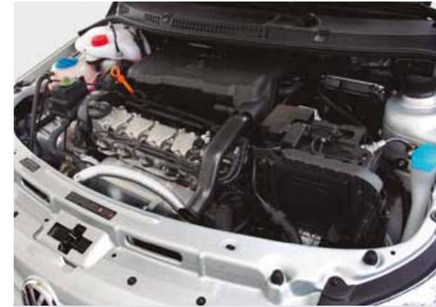
La Saveiro cuenta con el conocido motor 1.6L de 101 HP de potencia, que se destaca por su mejor torque a bajo régimen (143 Nm a 2.500 r.p.m.) y reducido consumo de combustible.
