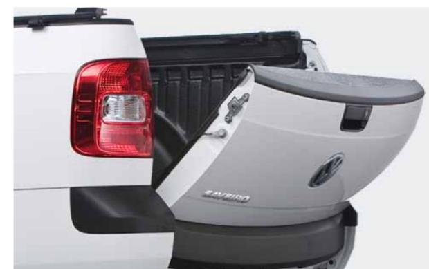
La Saveiro es el único vehículo utilitario del mercado que posee un sistema que reduce los esfuerzos de movimiento en la apertura y cierre de la puerta trasera, garantizando mayor confort y seguridad. Gracias a un resorte a gas, después del cierre de la puerta, el peso queda equilibrado evitando una posible caída indeseada.
